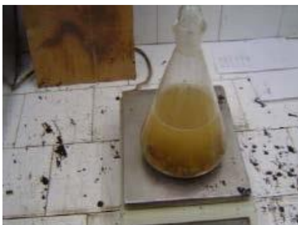
Figura 244 - 4. Determinación de la masa del picnómetro, sin llenar totalmente de aceite, más la muestra de agregado
